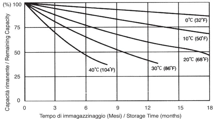
**FIG.2** Immagazzinaggio in funzione di temperatura.
