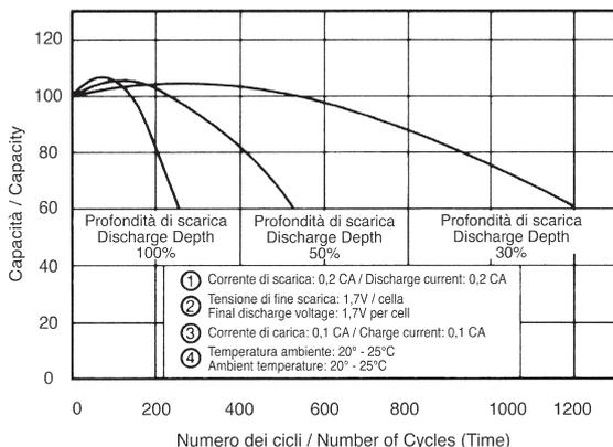
**FIG.6A** Vita in tampone delle batterie da 0,8Ah to 18 Ah.
