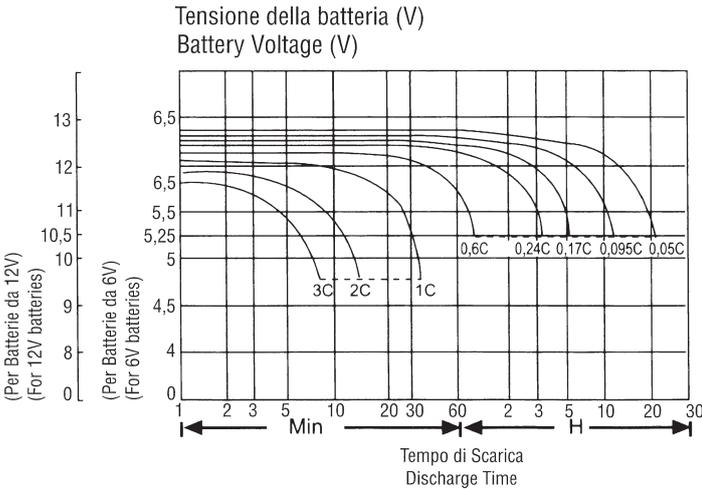
**FIG.9** Curve di scarica per batterie da 26Ah a 200Ah
