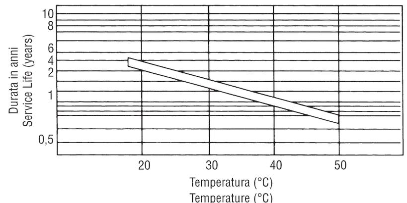
**FIG.6B** Vita in tampone delle batterie da 26Ah a 200Ah
